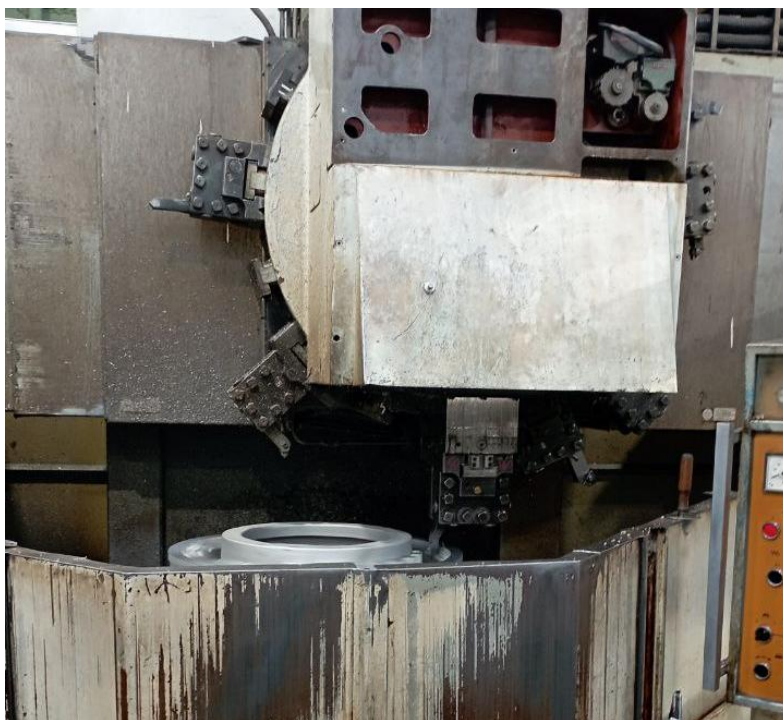
Рис. 1. Специализированный токарный станок SKQ-8NC для обработки крупных корпусных деталей. На таких станках проводятся длительные черновые и чистовые операции
