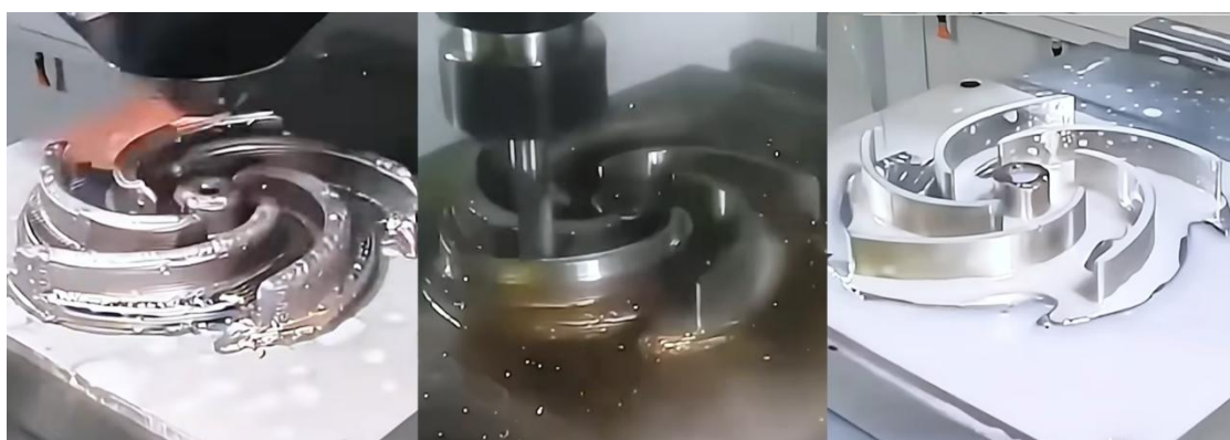
Рис. 5. Комбинированный обрабатывающий центр, состоящий из высокоскоростного принтера печати металлом и станка фрезерной финишной обработки
