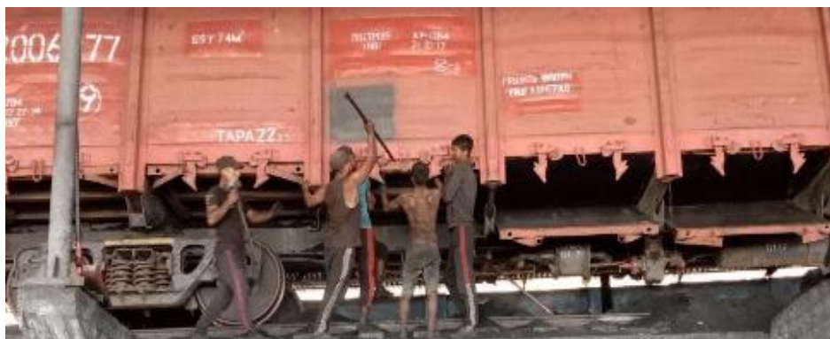
Рис. 1. Фрагмент поднятия нижних люков полувагонов вручную
