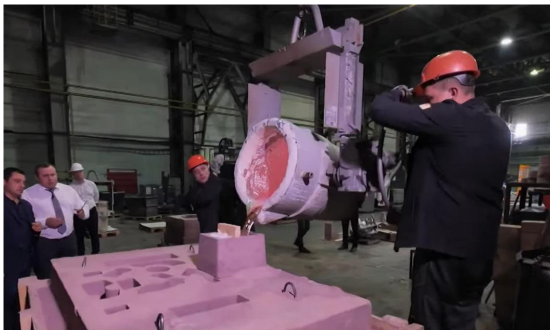
Рис. 2. Литейный цех завода «Калужский двигатель». Процесс заливки алюминия в форму заготовки
