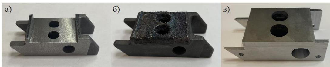
Рисунок 20 – Внешний вид литой заготовки (а), заготовки после наплавки (б), готовой детали (в)
