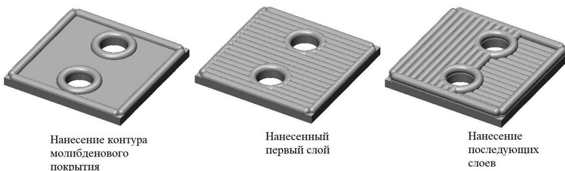
Рисунок 16 – Схема наплавки и стратегия сканирования
